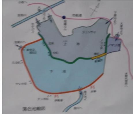
(2) **落合池**は灌漑用の溜池として、寛文6年(1666)から寛文10年ごろに築造と推定される。「寛文村々覚書」に記述)池の名は大草山、下原村、大泉寺方面からの水が流れ込む所から付けられた。面積約20町歩、標高46メートル。水深1尺5寸から2尺。灌漑面積(当時)38町4反余。池の特徴は普通は掘って造るが、平地に土手を造り水を溜める造りである。堤防から水が出ると、周辺地区に水が溢れ出て水害を広める。
